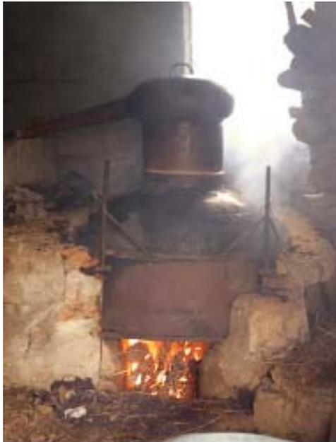
すべてが動きだしています。ポットの下火は燃え盛り、ポットの中の水を温め、次第に水蒸気となり、Brolho を通り、樽状のキャスクフードの中に集まり、逃げ道を探して、像の鼻のようなパイプを通り、冷却槽へと水蒸気は入ってゆきます。1 時間から 1 時間半ほど、かなり強い火力を保ちます。
