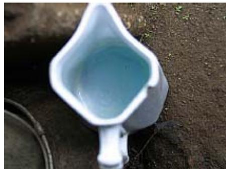
しばらくすると、最初の結果…ちよろちよろと冷却槽のパイプからグラッパワインブランデーが滴り落ちます。この初期の部分、ヘッドは、もちろん、飲料には適していないので分けておきます。実際、この部分はブルーぽく色づいています。これは銅製のパイプでは当然のことですが、一年間放置されていた冷却槽のコイルの内側に付着していた汚れ、不純物を最初の蒸留で清掃したせいです。
