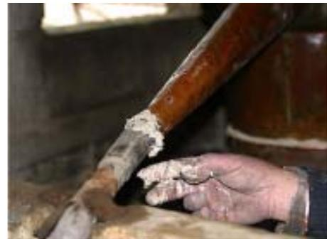
次にライ麦粉に水を混ぜてドーナツを作るような、柔らかいパテを作り、キャスクフードの蓋とポットの間、或いは冷却槽のパイプとキャスクフードの蓋のパイプのつなぎ目にこのパテをしっかりと塗ります。アランビックは銅で出来ており、火にかけるとすぐに熱くなり、パテが固まるので、このようにパテを塗ることにより、大切なグラッパが、隙間から水蒸気の状態で逃げてしまうことを防ぐことができます。
