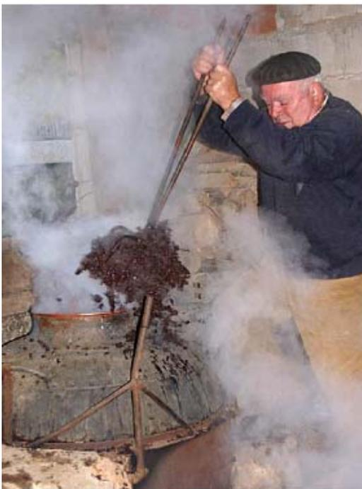
レオナルドはポットの火を消して、ポットが冷めるまでしばらく待ってから、Brolho がポットから剥がれるようにポットを強く叩きました。まだ、かなり熱いのでタオルを巻いてキャスクフードと呼ばれる蓋を外し、ピンセット形のクランプでポットの中の Brolho を出来るだけ多く挟んで、何度かに分けて取り出しました。
