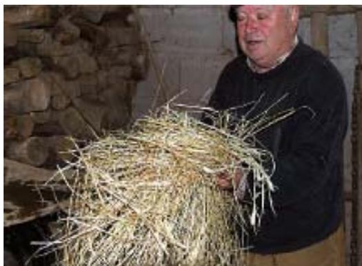
レオナルドはポットの中を覗いて、正確に水の量を測ってから、ライ麦のわらをいっぱいにつかみ、銅製のポットの中に敷いています。これはわらを敷くことによって、蒸留してる際に、火が、或いは熱源が直接ポットの中の物に当たらず、グレープブランデー、すなわち出来上がったグラッパが焦げ臭くならないための知恵です。
