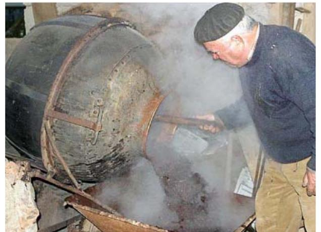
ポットの周りにベルト状に巻いてある金具の先端を手前に引いてポットを傾けて、まだ熱く、アルコールを含んだ水蒸気に気をつけながら、ポットを空にしました。
