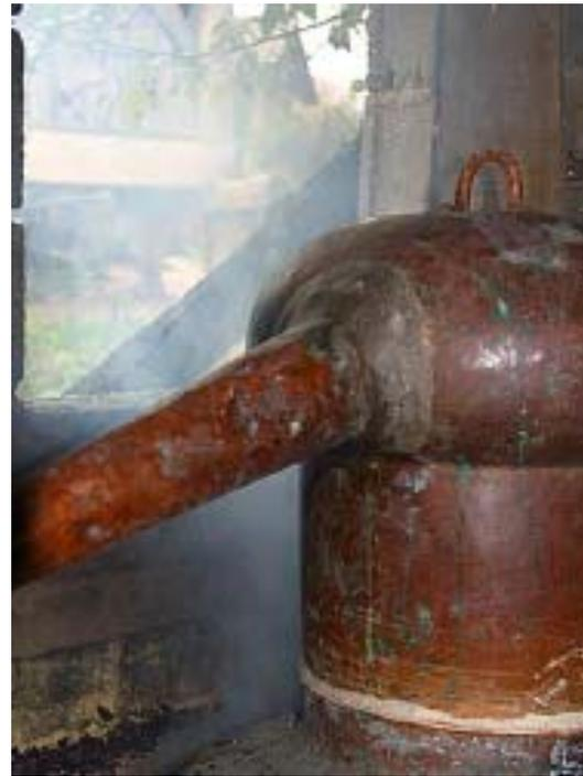
レオナルドは冷却槽に近づき、冷却槽の水よりほん僅かに飛び出している冷却パイプのうえに手をかざし、冷却槽に張ってあった水はかなり熱くなり、蒸気が立っているのがわかりますか、このパイプの部分に手を近づけてみると、ポットの火力が十分であるかどうか分かるそうです。
