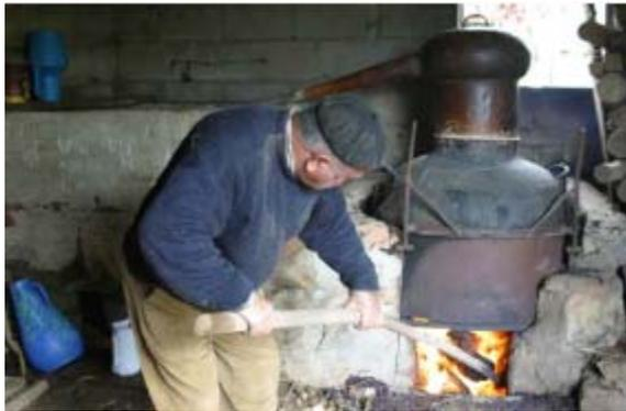
レオナルドは長い棒でポットの下の燃え盛る炭を広げるようになり、火力が幾分落ちたところで、鉄の板で空気口を半ば塞ぐことによって空気の流入を半減し、コンスタントに細火の状態を保つようにしています。
