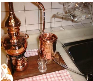
1. 点火後しばらくするとポットのお湯が沸騰して冷却槽の水温も上昇を始めます。ポットの口や接合部から水蒸気が逃げないか確認して下さい。
