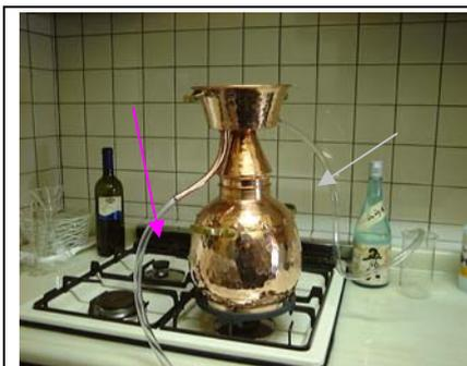
冷却槽に付属のビニールチューブを取り付けます。
