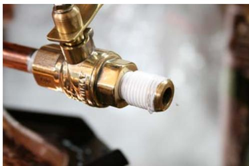
\* 写真は20.0L用の接続パイプですが3.0Lでもヒーティングポットの接続部などには必ずシールテープをきつく巻いてくいてからねじ込むと水漏れがしにくくなります。
