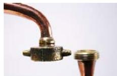
1. ガスコンロの上にポットを置きます。冷却槽の下に台などを置き、グースネックパイプと冷却槽をネジ式ロックで繋げるように高さ調節をして、ネジ式ロックを締めます。
