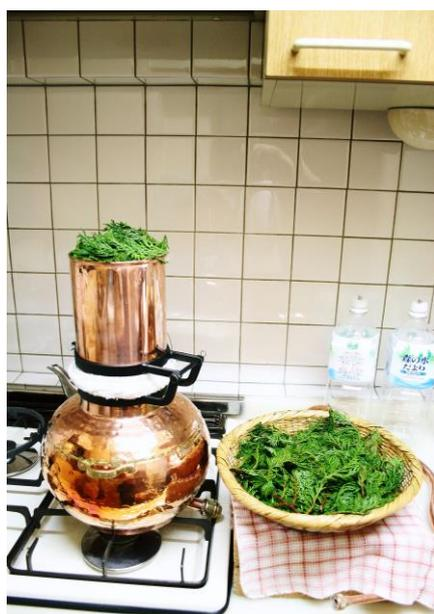
\*左の写真のヒバなどのように葉や茎などが付いている場合はある程度きつく詰めても葉と葉の間に隙間があるので水蒸気が通りますが、花卉だけを蒸留する場合は花卉だけではなく茎や葉も一緒に詰めて隙間を作り、必ず水蒸気が通るようにするか、もしくはカラムには少なめに入れ、同時にポットに水と一緒にに入れて煮出して蒸留したほうが良い場合も有ります。
