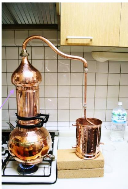
■ 一般的にハットの首は浅めにカラムに入るように作られています。特にサイズの大きなアランビックではハットが深くはめ込まれると使用後、ハットがカラムから外れなくなります。ハットの首の部分が深くカラム入ってしまう場合は必ずカラムやポットの口に布を巻き、使用後に外れるようして下さい。
