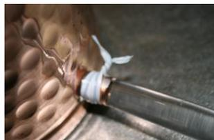
冷却槽に排水用ビニールチューブを取付けますが、冷却槽の水が熱くなると冷却槽のパイプとビニールチューブの間からビニールチューブが熱で膨張し水が漏れることがあるので冷却槽の下にタオルを敷いたり、写真のように付属のビニールタイをきつく巻き付けてください。ビニールタイは何度か使用できるので捨てないでください。
