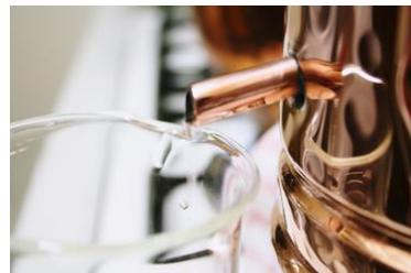
香りの強いものを蒸留し残り香が気になる時はお湯をポットに入れ、加熱し冷却槽に水を入れずに蒸気を放出させて洗浄する方法もあります。
